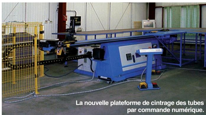
La nouvelle plateforme de cintrage des tubes par commande numérique.
